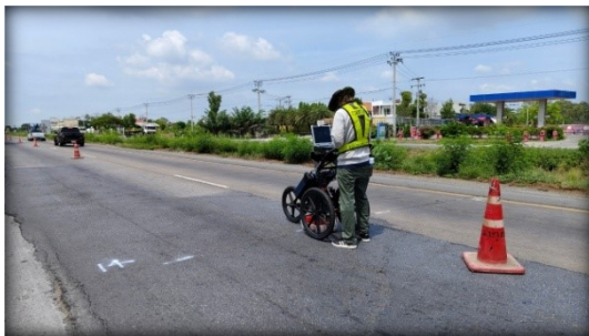
การสำรวจโพรงใต้ผิวทางจราจรด้วยเครื่อง GPR ทางหลวงหมายเลข 347
