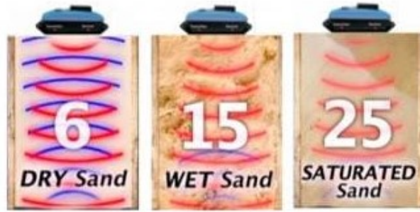
ภาพที่ 3 ลักษณะการสะท้อนของคลื่นสัญญาณในวัสดุที่มีความชื้นและค่าไดอิเล็กตริก (Dielectric Constant) แตกต่างกัน
