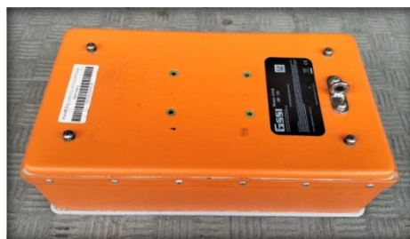
ภาพที่ 7 ลักษณะของกล่องตัวรับ - ส่งคลื่นเรดาร์ความถี่ 400 MHz และ 900 MHz
